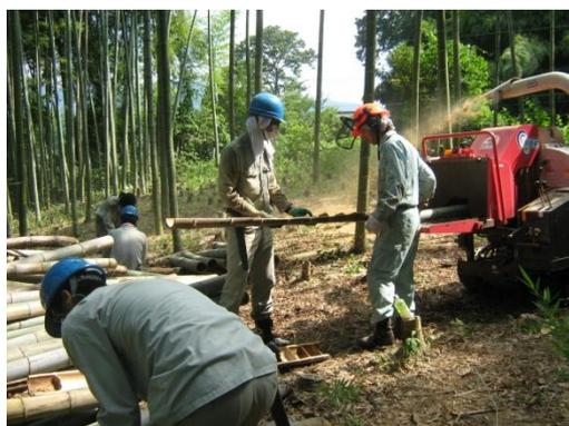
写真 9 伐採した竹の破砕作業
