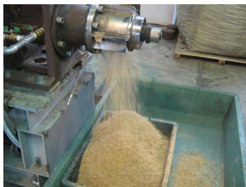
写真 10 籾殻の吸水をよくするために細胞を崩す加工
