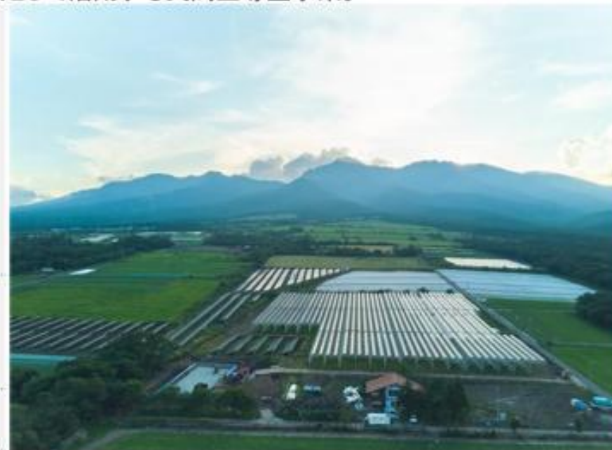
発電効率よりも農作業のしやすさを優先し、作業機械のサイズに合わせた設備設計。営農の面でも地主農家、若手営農者を中心として農地再生を進めている。
